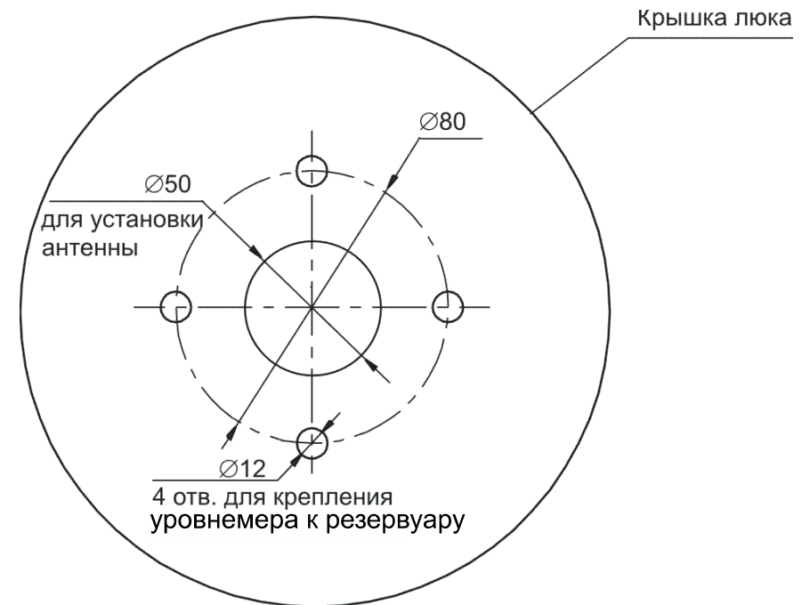
Рисунок 2 – Рекомендуемый вариант посадочного места ПП РДУЗМ-00 (01, 10, 20) на резервуаре
