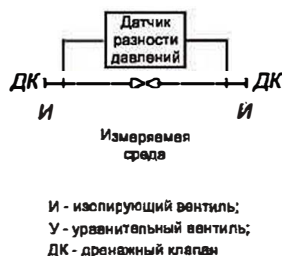
Гидравлическая схема тип 2: дренажные клапаны после изолирующего вентиля
