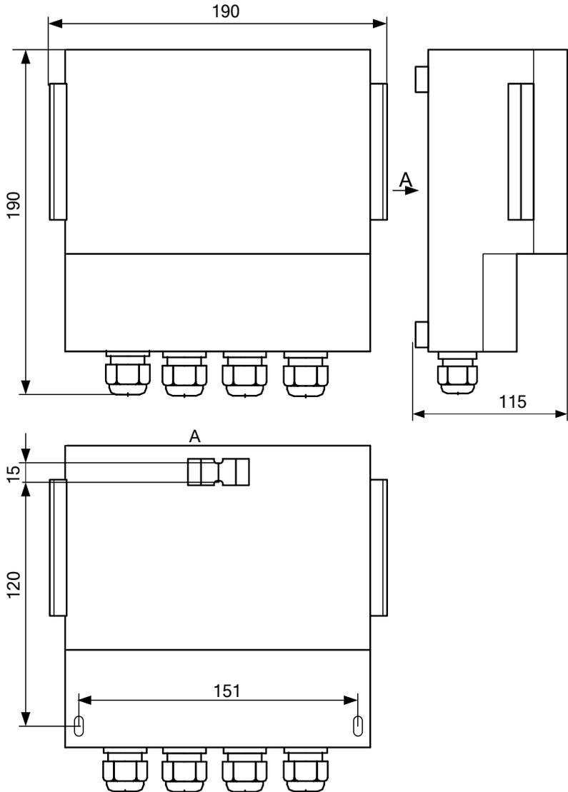
ЭСКИЗ КОММУТАЦИОННОЙ ПАНЕЛИ ЭЛЕКТРОННОГО БЛОКА БЭ-1
