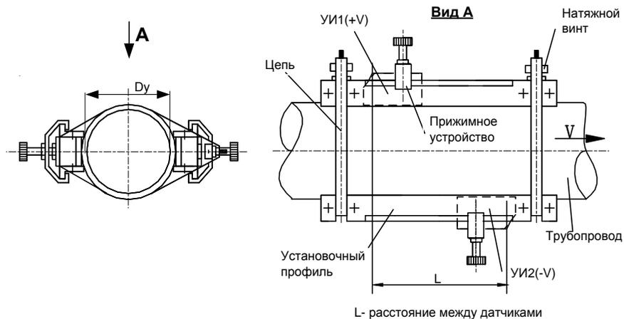
**Вариант крепления с помощью зажима**
