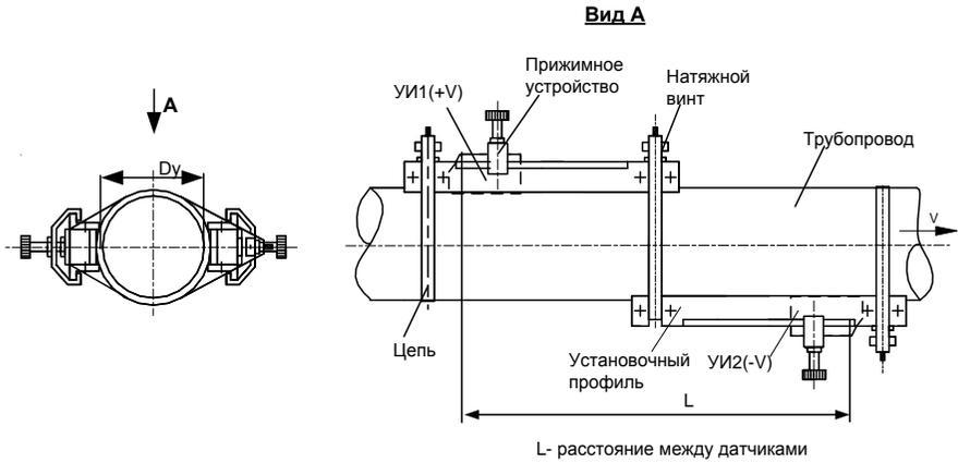
**Вариант крепления с помощью зажима**
