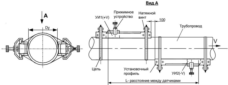
**Вариант крепления с помощью зажима**
