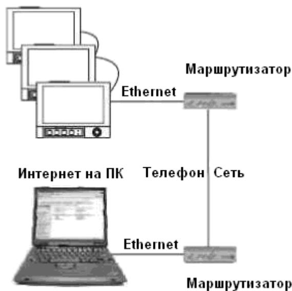
Рисунок 17 – Пример организации удаленного контроля с помощью веб-браузера
