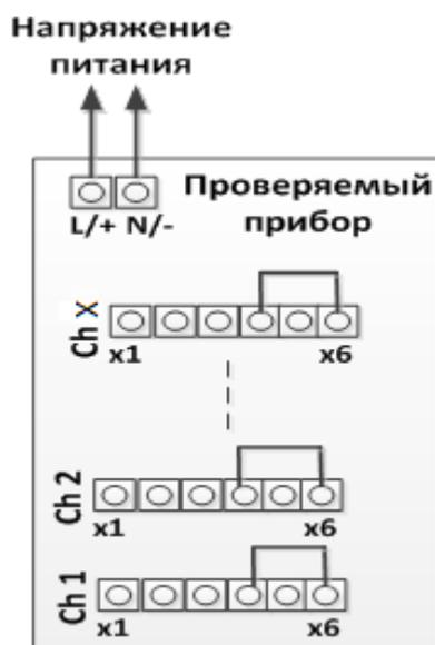
Рисунок Г.4 – Схема подключения для проверки компенсации температуры холодного спая
